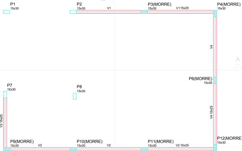
Forma do pavimento PLATIBANDA (Nível 400)
