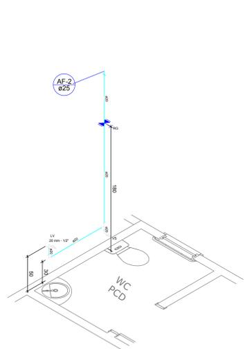
Detalhe ISOMÉTRICO Sanitário PCD Masc./Fem.
